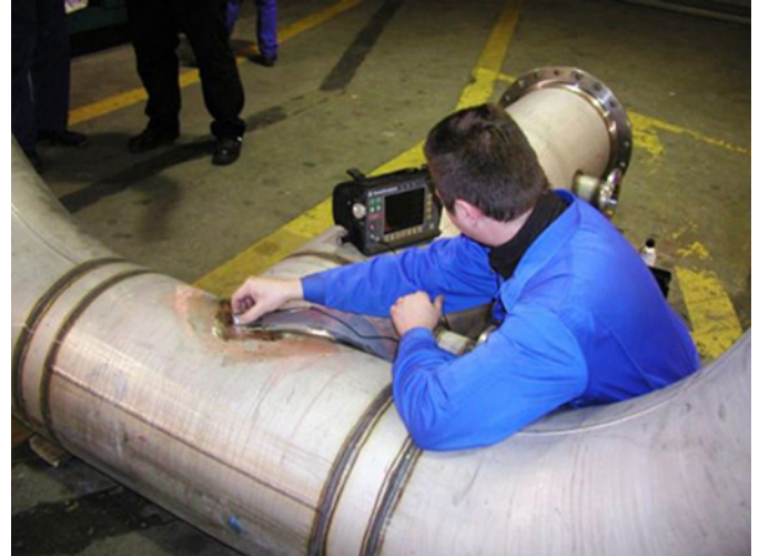
▲ Bild 14. Manuelle UT-Prüfung von Schweißnähten an einem T-Stück
