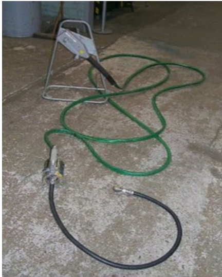
▲ Bild 9. Isotopenarbeitsgerät mit Ausfahrtschlauch (schwarz) und Fernbedienungseinheit
