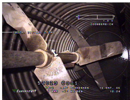
▲ Bild 3. VT-Prüfung von Behälterinnenflächen durch Videokamera: Einfahrvorgang in einen Behälter (links), Detailaufnahme einer Schraubverbindung (rechts)
