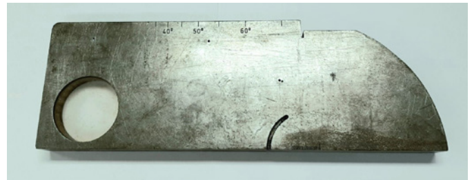
► Bild 15. Kalibrierstück für Ultraschallprüfungen
