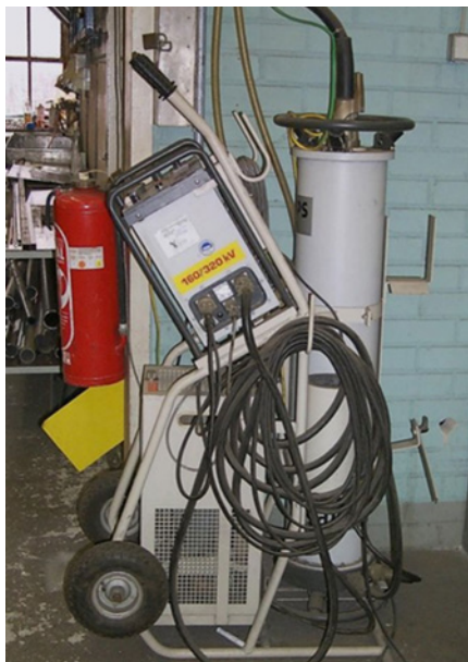
▲ Bild 7. Fahrbare Röntgenröhre für die Durchstrahlungsprüfung von Schweißnähten
