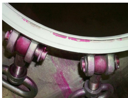
▲ Bild 4. Ergebnisse von PT-Prüfungen an Chemieapparaten: Bindefehler in einer Dichtflächenaufschweißung (links), Schweißnahtfehler in Halbrohrschlangenschweißungen (rechts)
