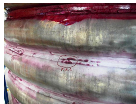
▲ Bild 4. Ergebnisse von PT-Prüfungen an Chemieapparaten: Bindefehler in einer Dichtflächenaufschweißung (links), Schweißnahtfehler in Halbrohrschlangenschweißungen (rechts)
