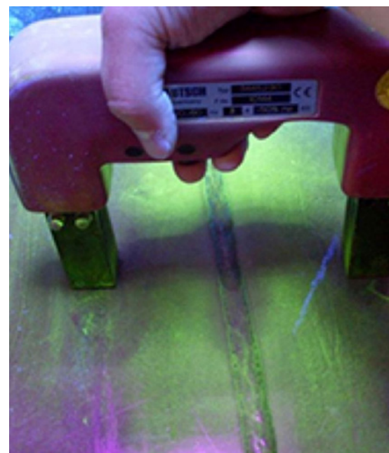
▲ Bild 5. MT-Prüfung einer Schweißnaht mit Handjochmagnet
