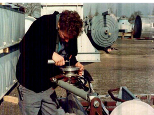
▲ Bild 1. VT-Prüfung einer Flanschsweißnaht mithilfe eines Spiegels
