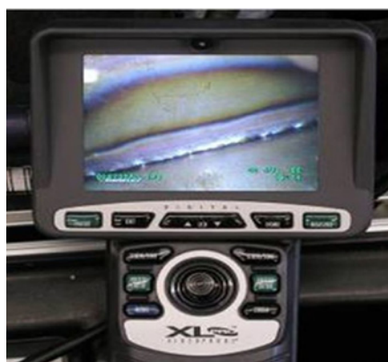
▲ Bild 2. VT-Prüfung von Schweißnähten durch Videoendoskop: Rohrrundnaht (links), Halbrohrschlangenschweißnaht (rechts)
