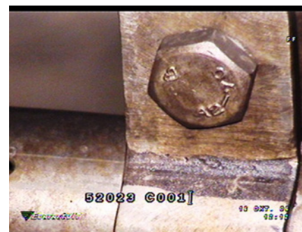
▲ Bild 3. VT-Prüfung von Behälterinnenflächen durch Videokamera: Einfahrvorgang in einen Behälter (links), Detailaufnahme einer Schraubverbindung (rechts)
